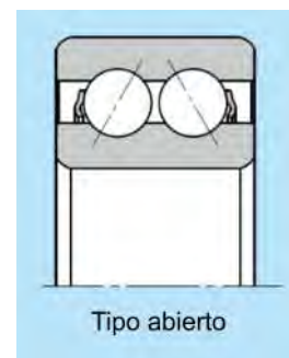
La disposición de los cuerpos rodantes en un rodamiento de bolas de contacto angular de doble hilera.
