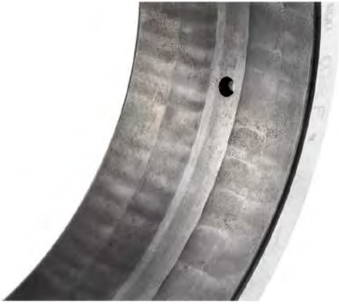
Este ejemplo muestra el pulido del material en la superficie de la pista de rodadura.
