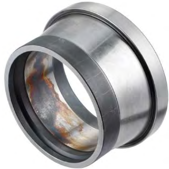
Este anillo interior está afectado por la corrosión por rozamiento.
