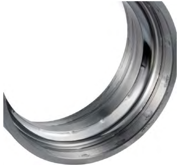
Aquí se pueden ver las deformaciones plásticas en un anillo de un rodamiento.
