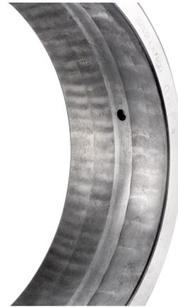
*Como ejemplo, puedes ver el desgaste en la [pista de rodadura](#) del anillo de este rodamiento.*
