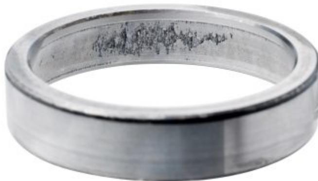
*En este anillo del rodamiento se aprecia una **exfoliación** profunda (pelado) que parte de la superficie. La exfoliación está causada, por ejemplo, por partículas extrañas en el lubricante que son arrolladas por los **cuerpos rodantes**, lo que puede derivar en daños posteriores en el rodamiento.*
